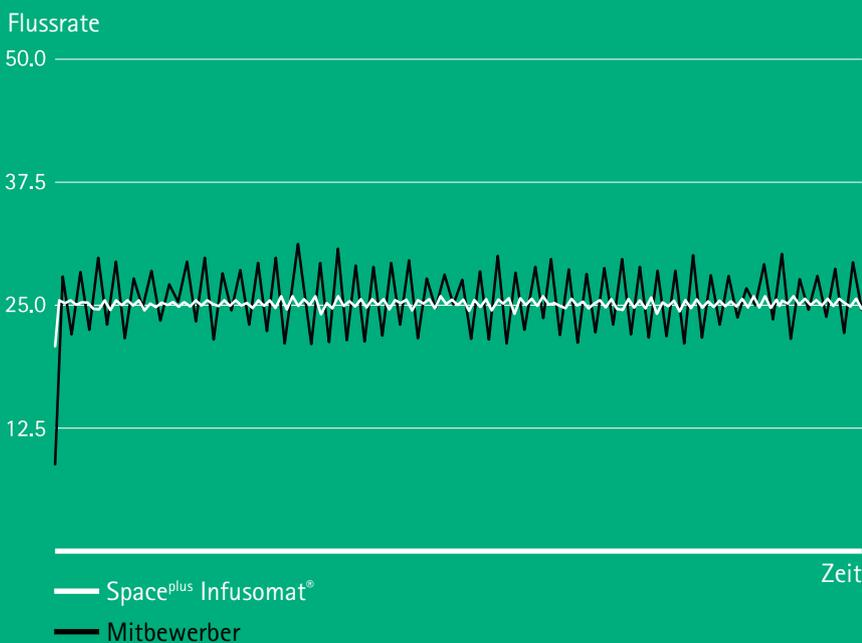
Die Grafik zeigt die Genauigkeit und Konstanz der Förderrate während der Laufzeit. Zu berücksichtigen ist, dass Fördercharakteristika und Fördergenauigkeit erheblich von den verwendeten Einmalartikeln beeinflusst werden.
