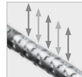
Reflexion der Ultraschallwellen
