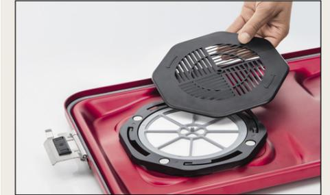
PRIMELine® Filter unbeschädigt (keine Knicke, Löcher, Risse oder Spalten). Filter bleibt bei der Überprüfung in der Kartusche.
